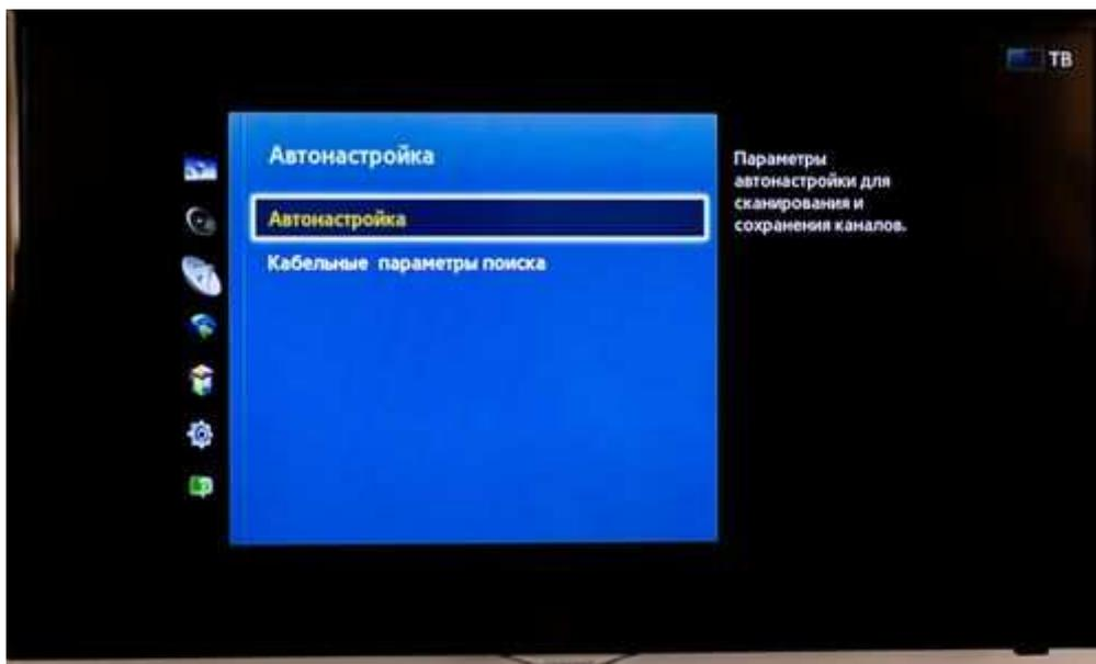
4. Выбираем ПУСК, нажимаем центральную кнопку на крестовине (готово)
