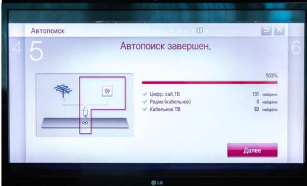
8. Для завершения настройки каналов нажимаем кнопку ГОТОВО
