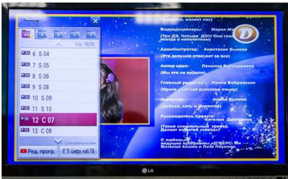
3. Выбор перемещаемого канала осуществляется с помощью стрелок на пульте. Для переключения списка каналов с цифровых на аналоговые нажимаем стрелочку вверх на пульте до выделения ЦИФР.КАБ.ТВ переключаем на КАБЕЛЬНОЕ ТВ. После выбора нужного канала нажимаем ОК. Далее нажимаем **ЖЕЛТУЮ** кнопку с тремя белыми точками.
